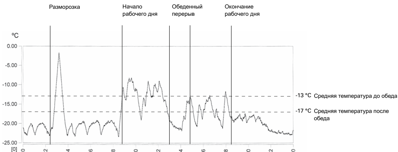
Суточные изменения температуры. Проем защищен завесами ADA Cool
